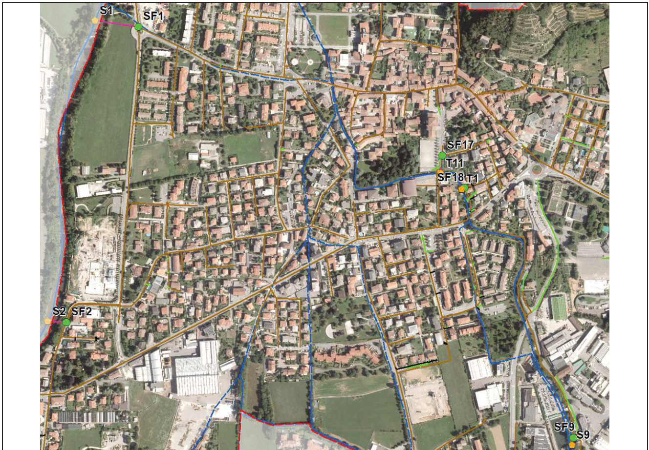
Figura 9: Planimetria della rete fognaria con gli sfioratori, gli scarichi e gli impianti di sollevamento.
